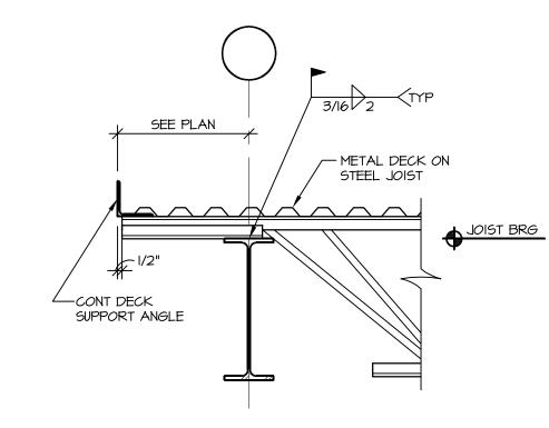
JOIST BEARING SCALE: NONE
