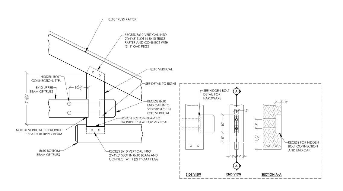
RECESS 8x10 BEAM INTO 2"x4"x10" SLOT IN 8x10 TRUSS RAFTER AND CONNECT
